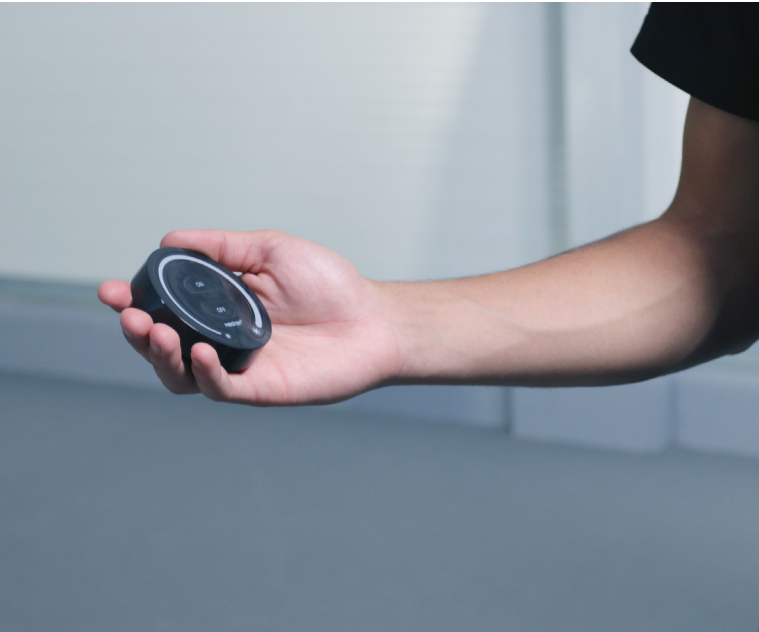
Fernbedienung für die Beleuchtung (Ein-/Ausschalten und Dimmfunktionen).
